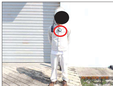
รูปที่ 3-33 Gas Detector สาร HCN ชนิดพกพา สำหรับพนักงาน
