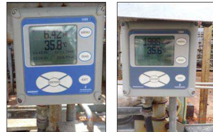
เครื่องตรวจวัด pH และ Conductivity แบบอัตโนมัติ บริเวณบ่อบำบัดน้ำทิ้งจากหน่วยผลิตกรดซัลฟูริก (SAR)
